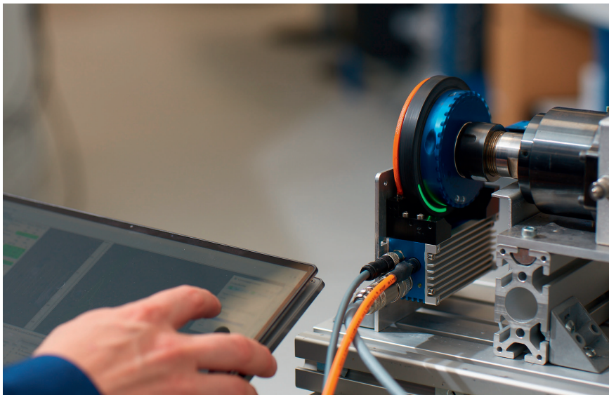
4 Ohne Umwege dort messen, wo das Geräusch entsteht. Der TAC-Sensor von Discom überträgt die Winkelbeschleunigung auf das Dashboard mit der passenden Software
